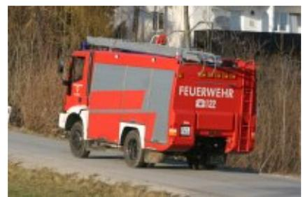
Unser TLFA mit 2000 l Wasser und einer Besatzung von 3 Mann ergänzt bei größeren Einsätzen nicht nur das KRFB, sondern dient auch zu Wassertransporten, Kanalreinigungen und anderen technischen Hilfeleistungen. Ausgestattet ist das Tanklöschfahrzeug mit:
